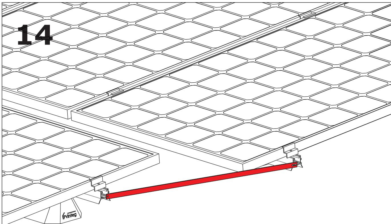
Blitzschutz zwischen den Reihen mit Selbstbohrschraube befestigen
